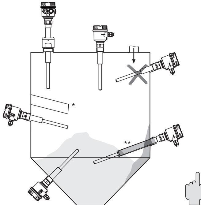
senkrechter Einbau/vertikaler Einbau
