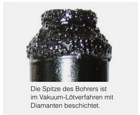
Die Spitze des Bohrers ist im Vakuum-Lötverfahren mit Diamanten beschichtet.
