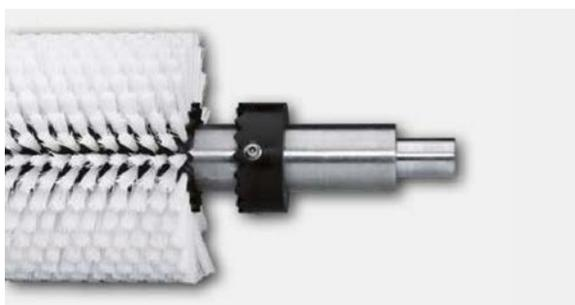
Mit den jeweils passenden Multi-Zack Stellringen werden die Multi-Zacksegmente auf der Welle positioniert und gesichert. Durch die Verzahnung wird die Mitnahme und die Drehmomentübertragung gewährleistet.
