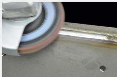
Schweißnahtabtrag und attraktives Finish in einem Arbeitsgang
