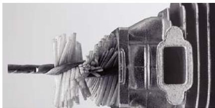
**Empfehlung:** Bürstenübermaß von 10-15 % zur Bohrung, bitte oszillierend einsetzen
