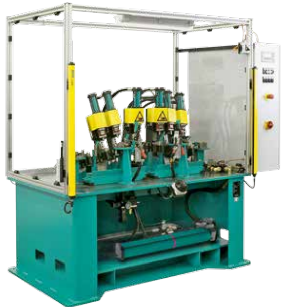
Presse mit TOX®-Kraftpaket X-KT-System: 1 Druckübersetzer und 6 Antriebszylinder.
